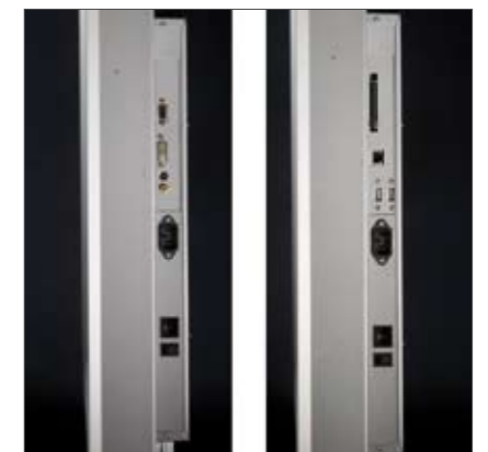
Anschlussfeld Albra Video - Alle Anschlüsse befinden sich seitwärts - gut zu erreichen, leicht zu sichern mit der optional verfügbaren Anschlussblende.
